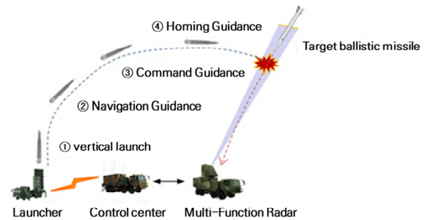
그림 3. 표적 탄도탄 요격 운용개념 Fig. 3. Targeted ballistic missile interceptor operation concept
