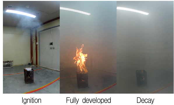
그림 2. 종이를 이용한 화재 상황 모사 Fig. 2. Simulation of fire situation using paper
