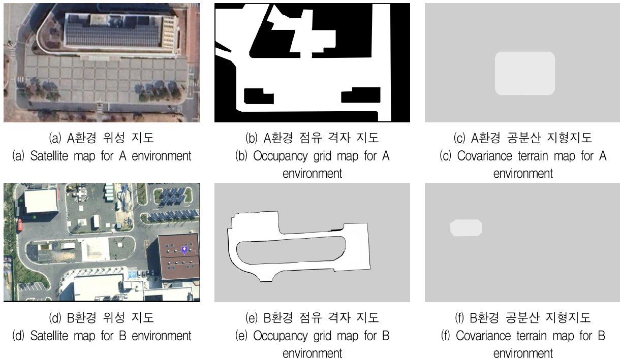
그림 3. 시뮬레이션을 위해 취득된 A와 B 환경, 점유 격자 지도 및 공분산 지형지도. 로봇은 점유 격자 지도의 흰색 영역에서 이동이 가능하고, 공분산 지형지도는 불확실성이 높은 영역(연한 회색)과 낮은 영역(진한 회색)으로 표현한다.
